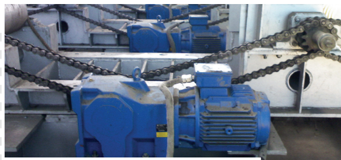
Motoredutores de engrenagens cônicas para mesas de alimentação em leitos de resfriamento
