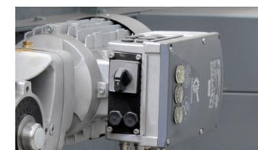
Les commutateurs et boutons sont directement disposés sur les entraînements et permettent le démarrage direct, l'arrêt ainsi que les modifications de mode.
