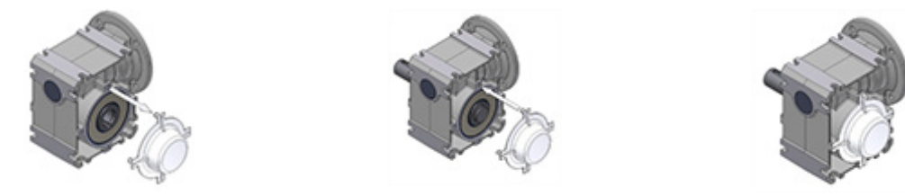
Рисунок 14: Монтаж и демонтаж крышки
