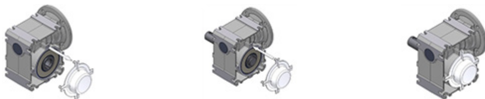
Rysunek 14: Demontaż i montaż pokrywy
