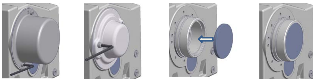
Rysunek 13: Montaż pokrywy w opcjach SH, H i H66
