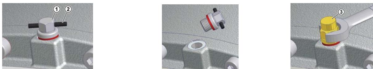
插图 22：取出排气螺栓，换上特种排气螺栓
