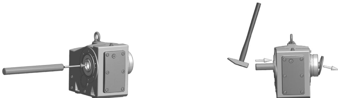
**插图 5：拆卸制造商已安装的密合盖**
