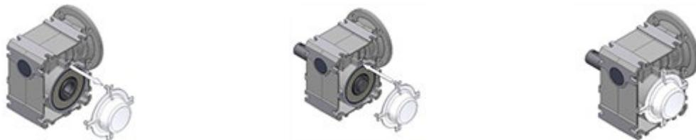
插图 14：拆卸或安装防护罩
