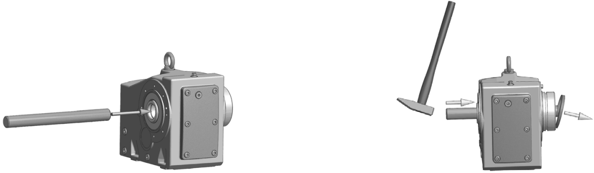
그림 5: 출고 시 설치된 잠금 캡 제거 방법
