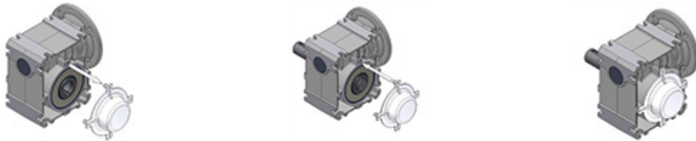
그림 14: 커버 캡 분해 및 설치 방법
