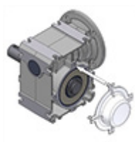
Attēls 14: aizsargvāka demontāža un montāža
