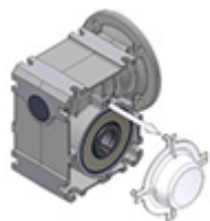
Attēls 14: aizsargvāka demontāža un montāža
