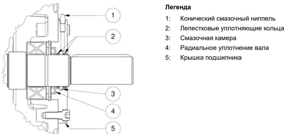
Рисунок 31: Проверка таконитового уплотнения
