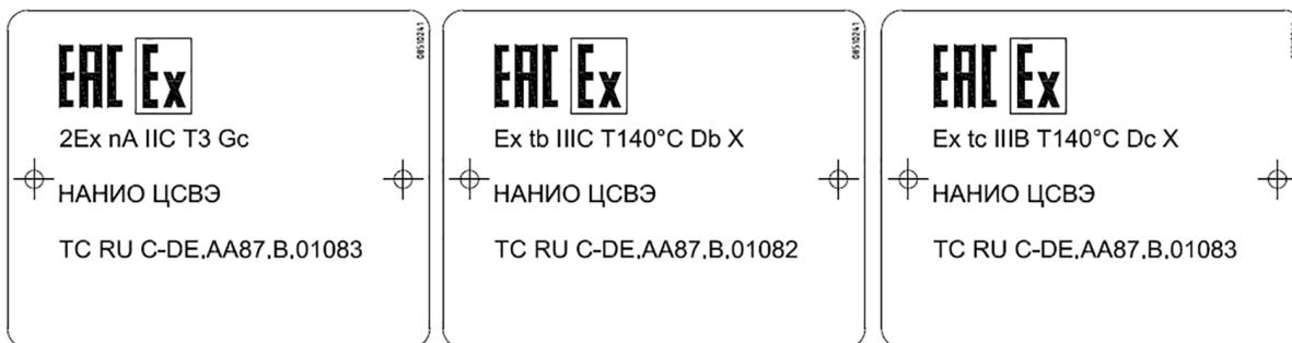
Эксплуатация двигателей разрешается только в таких условиях, для которых является допустимым класс взрывозащиты, указанный на его типовой табличке. Обязательными для соблюдения являются также указанные на типовой табличке температурные классы и максимальная допустимая температура поверхности.
