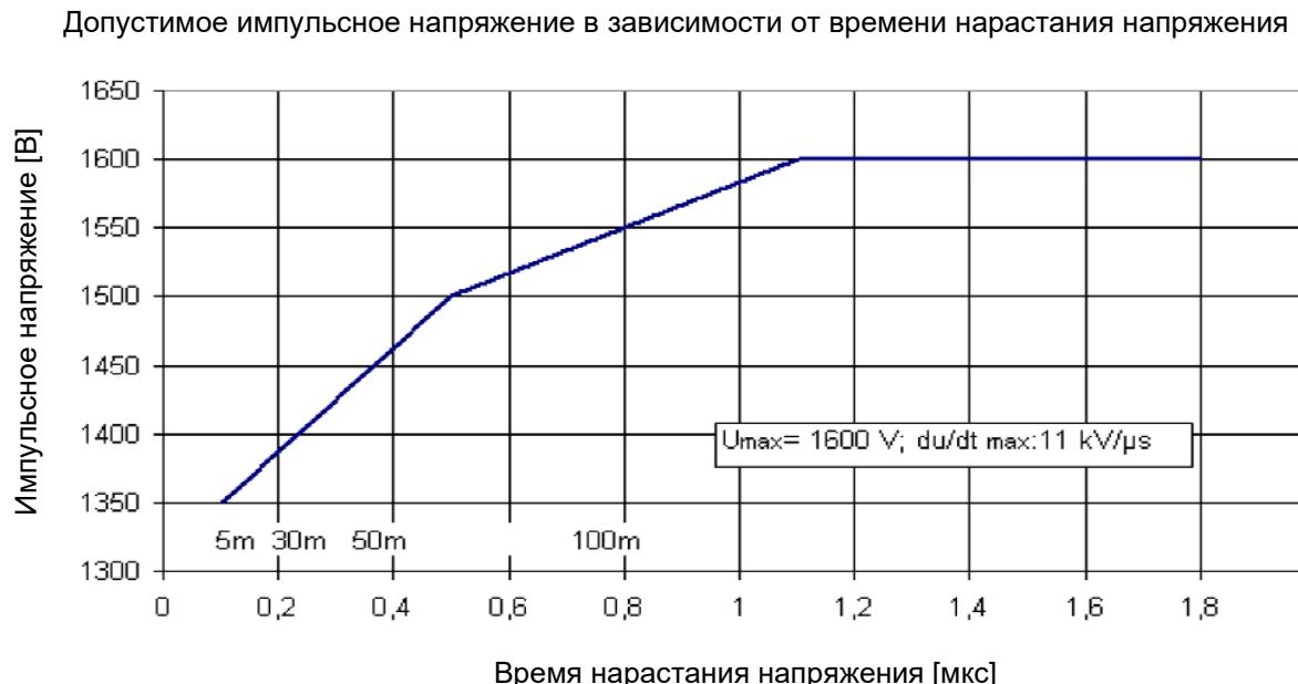
Если значения выходят из допустимых диапазонов, возможна фильтрация  $du/dt$  или синусоидальная фильтрация напряжения (с учетом дополнительных падений напряжения).
