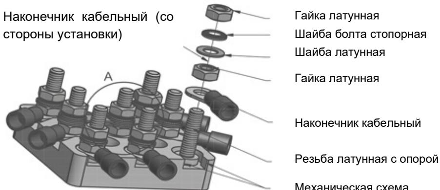
Для заземления электродвигателя следует использовать один из указанных заземляющих контактов.
