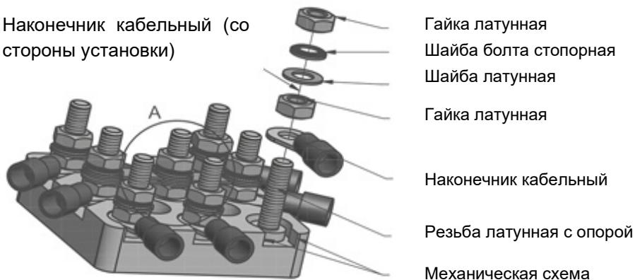
Для заземления электродвигателя следует использовать один из указанных заземляющих контактов.
