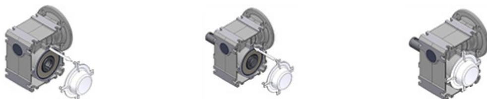
Рисунок 15: Монтаж и демонтаж крышки
