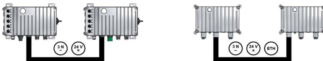
Figura 2: daisy-chain NORDAC ON e NORDAC ON+ Figura 3: daisy-chain NORDAC ON PURE
