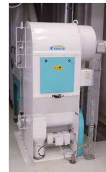
**Addetto alle pulizie.** Un azionamento NORD permette di allontanare le frazioni a bassa densità dal separatore a circolazione d'aria.
