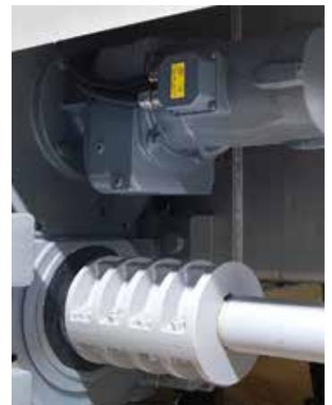
**Fahrtrieb.** – Das BLOCK Flachgetriebe mit Stirnrad-Vorstufe bewegt die Mälzerei-Wender auf Schienen über den Saladin-Behälter.
