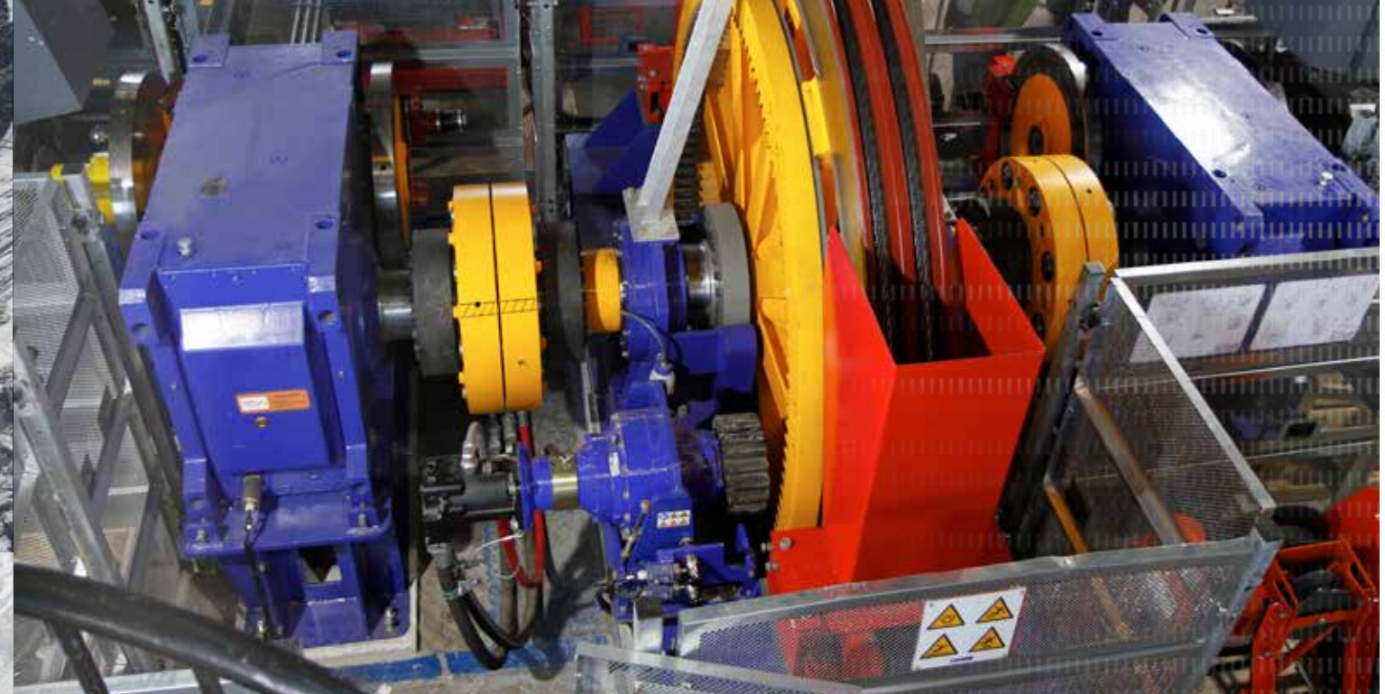
Tignes, a 2.000 m, es el centro de la estación de esquí de Espace Killy en el departamento francés de Saboya. Para la modernización de un importante teleférico en la Grande Motte, el fabricante suizo de teleféricos Garaventa con ó en los reductores industriales ables y de bajo mantenimiento de NORD DRIVESYSTEMS.
