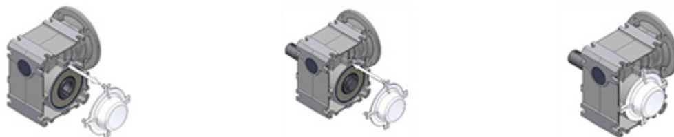
Slika 15: demontaža i montaža pokrivne kapice
